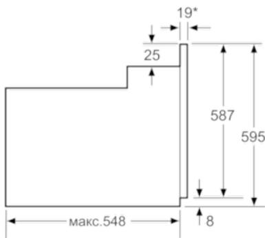
\* При металлической фронтальной панели 20 мм
